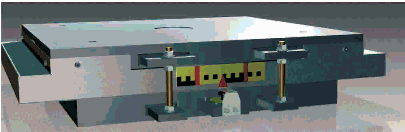
Lagăr recipient TGe asamblat cu protecție pentru elementele de alunecare
